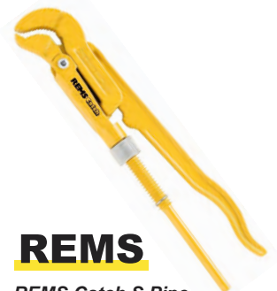
REMS Catch S Pipe Cevna klješta Hrom-vanadijum čelik. Kovane iz jednog komada čelika, sa čeljustima za sigurno stezanje u tri tačke. Kaljeni, čvrsto zatvarajući zubi. Dimenzije: 1/2" - kataloški broj 116000 1" - kataloški broj 116005 1 1/2" - kataloški broj 116010 2" - kataloški broj 116015 3" - kataloški broj 116020
