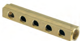
MS razdelnik/sabirnik FF art. 1101 "Icma" Dimenzije: 3/4", 1" Razmak između priključaka 37,5 mm Priključak: unutrašnji navoj 1/2" Broj priključaka: 2-10
