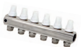
MS sabirnik FF sa ventilima sa termostatskom opcijom art. 1001, "Icma", povratni vod Dimenzija: 1"; Broj priključaka: 1-15 Razmak između priključaka 50 mm Priključak: Spoljni navoj eurokonus 3/4"
