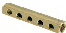
MS razdelnik/sabirnik FF art. 1102 "Icma" Razmak između priključaka 50 mm Priključak: unutrašnji navoj 1/2" Za dimenzije 3/4", 1", 5/4" broj priključaka 2-10 Za dimenzije 1", 5/4" broj priključaka 2-15
